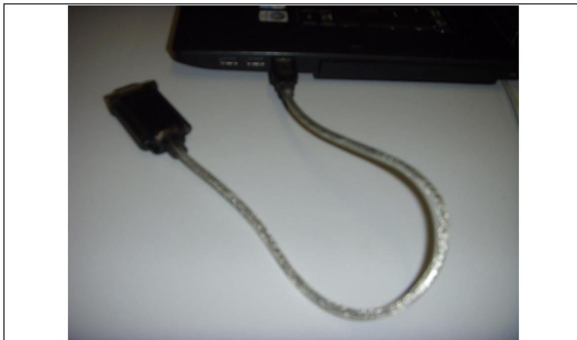
Figura 5 – Exemplo de ligação do Conversor à porta USB de um PC
