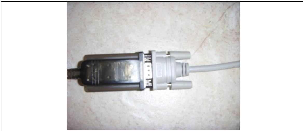
Figura 15 – Apontamento fotográfico da ligação do Conversor ao cabo RS232 do NA27
