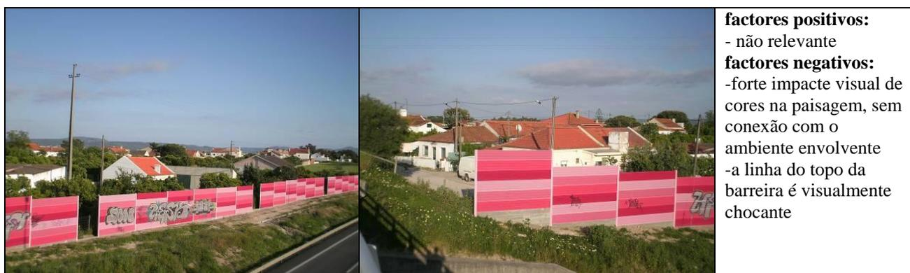
Figura n 6 – Exemplo de Barreira Acústica ao longo do IC21
